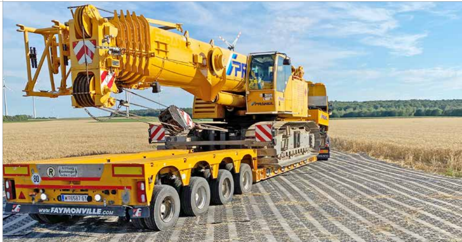
Im Windpark Scharndorf wurden über die rund 1.000 MRS Medium Bodenschutzplatten der Firma TWF im Laufe der 10 Einsatztage Schwertransporte mit einem Gewicht von ca. 4.160 t transportiert.
