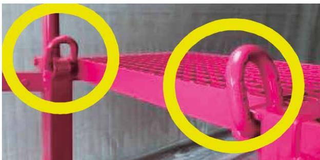
2 Anschlagpunkte für die Anbringung von Hebeketten sind am oberen Podest vorgesehen.
