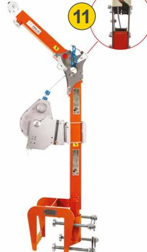
Führen Sie nun das Seil zwischen den Führungen und über eine der Seilrollen der Auslegerspitze. Stellen Sie sicher, dass Sie die gleiche Seitenrolle wie für die hintere Seilrolle verwenden
