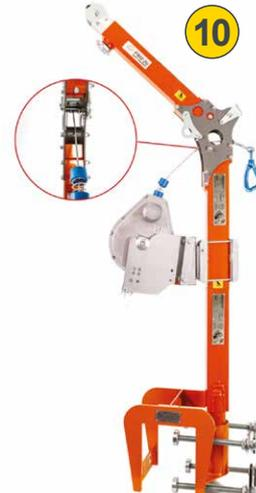
Schieben Sie den Haken der Rescue Recovery-Winde durch die Öffnung der Umlenkrolle für die vordere Halterung und lokalisieren Sie das Seil auf der Rolle. Führen Sie dann das Kabel zwischen den Führungen und über eine der hinteren Seilrollen.
